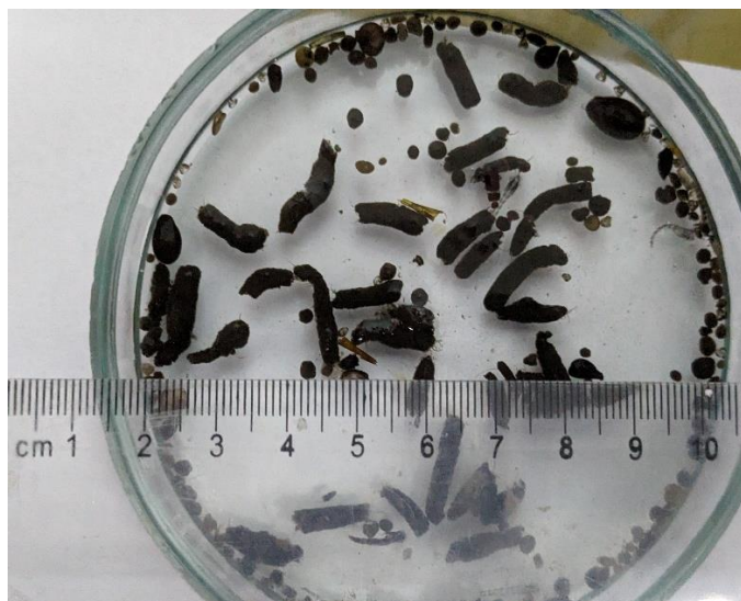
Figura 3.1 Coconi aglomerate de microorganisme colectate din fluxul ciclului tehnologic la linia experimentală a SEB
