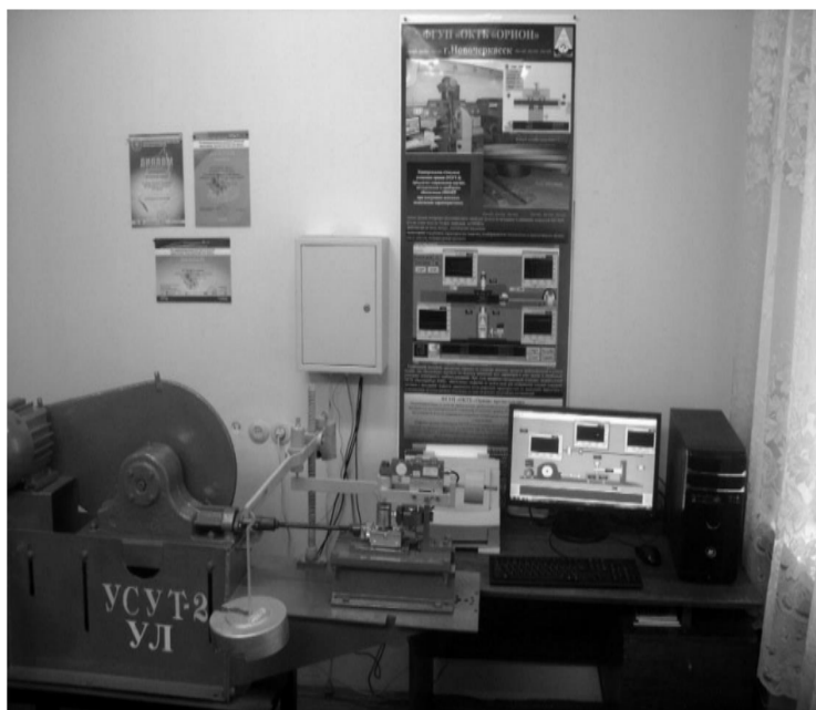
Fig. 1.9. Tribometru expres USUT-2-UL. Vedere generală [63]
