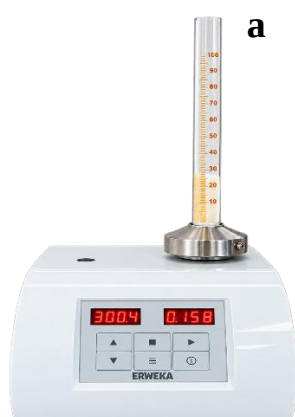
Figura 6. Aparatul de tasare ERWEKA SVM 221 (a) și Pâlnia vibratorie VP-12A (b)
