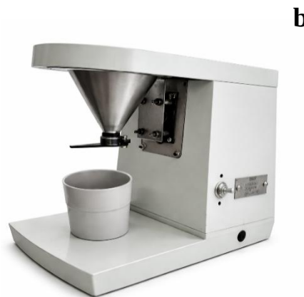
Figura 6. Aparatul de tasare ERWEKA SVM 221 (a) și Pâlnia vibratorie VP-12A (b)
