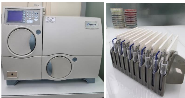
Figura 2.4. Analizator automatizat VITEK 2 Compact (stânga) și carduri speciale utilizate de analizatorul VITEK 2C (dreapta) (original)
