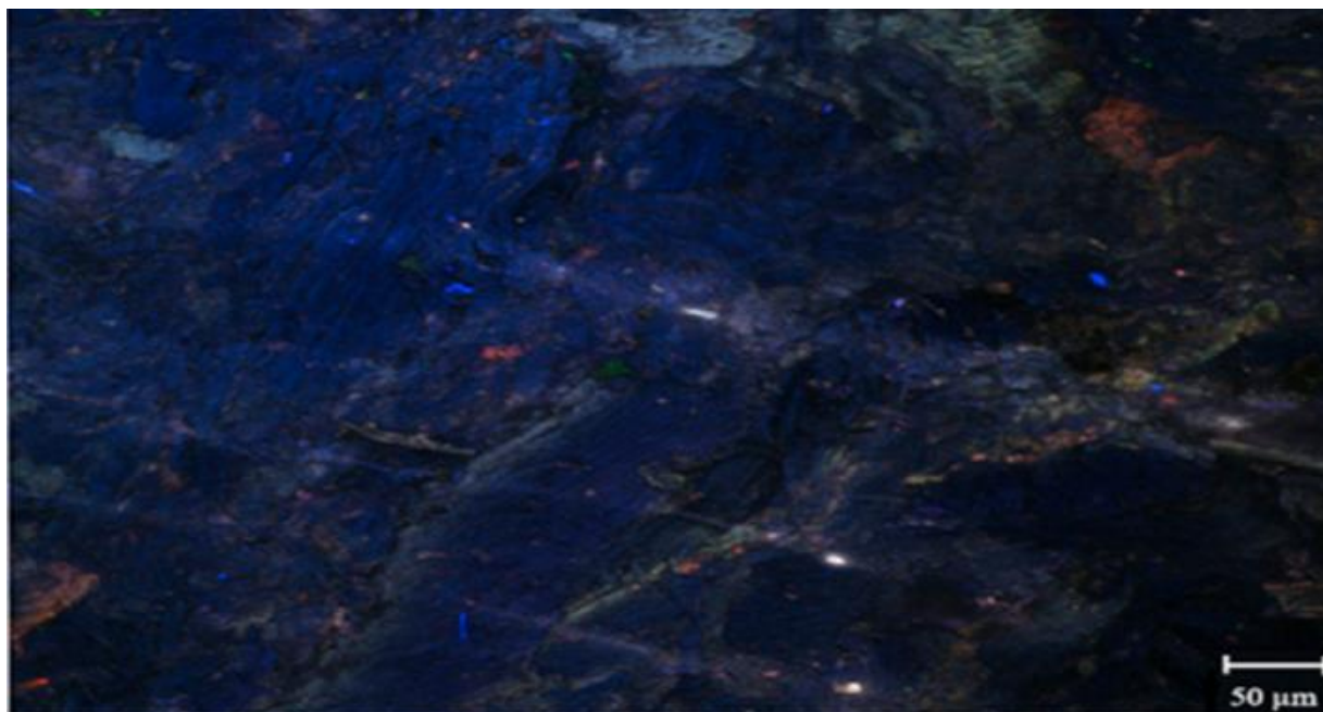
Fig. 4.1. Distribuția ligninei în secțiunea transversală a peleiților produși din Miscanthus observată prin microscopie cu fluorescență confocală.
