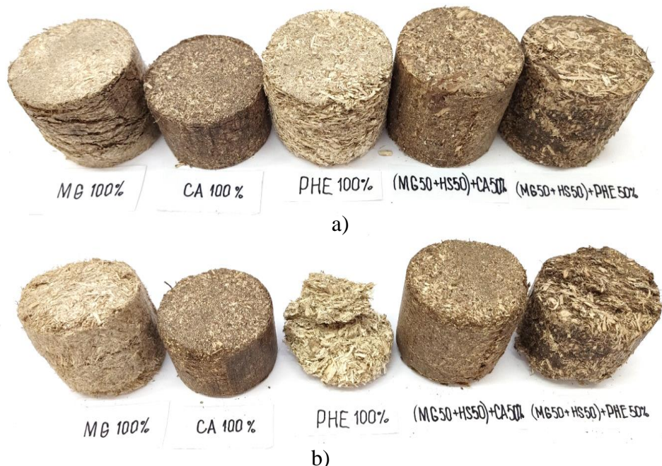
Fig. 4.7. Probe de brichete densificate din MG 100%; amestec de MG + HS și amestecuri de CA30%, restul amestec de MG și HS în proporții egale, a) înainte și b) după încercări la durabilitate
