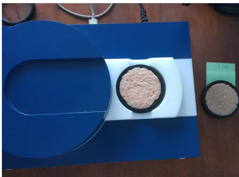
Foto 2. Pregătirea probelor pentru determinarea compoziției chimice a cărnii la aparatul „Cagle lab's”
