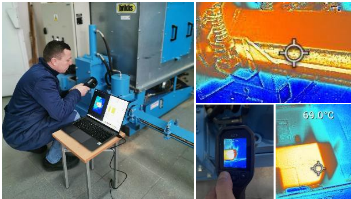
Figura 4.7. Imaginea termografică a matricei și secvențe din timpul monitorizării variației temperaturii matricei pe parcursul producerii brichetelor din reziduuri vegetale pomicole
