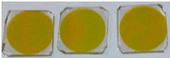
Рис. 3.1. Общий вид слоёв CdS на стеклянных подложках.
